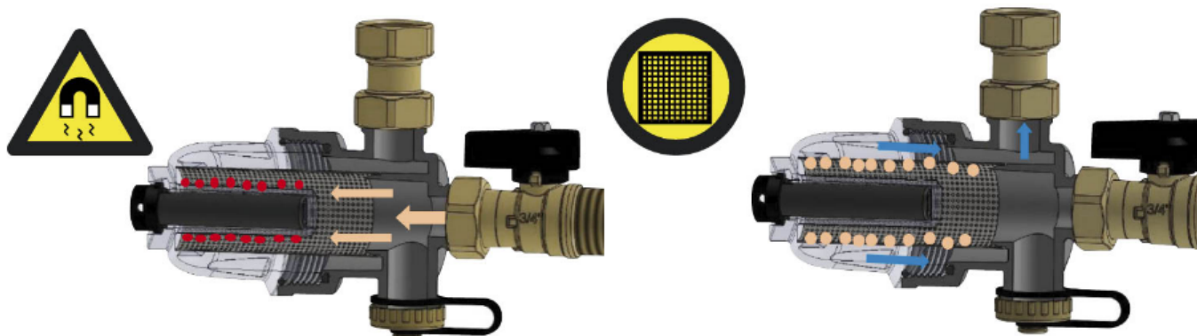
Przyciąganie zanieczyszczeń przez magnes
